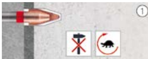
Loch in Steinzeugfliese bohren mit C-Protector.
